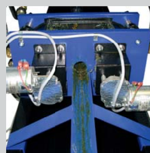
Laufriichts- und drehzahl geregelter Motor 24 V DC.
